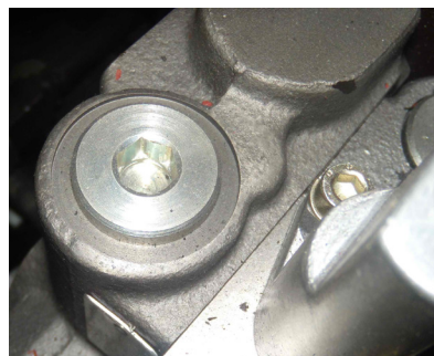
Figura 17e – Tapón del filtro de depuración basta.
